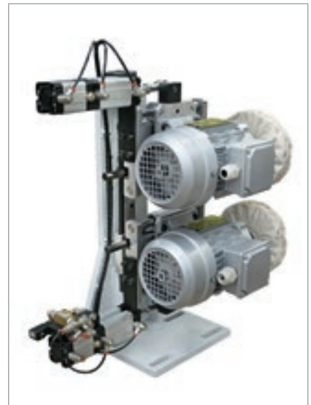
Grupo de escovas para a limpeza e o polimento da borda e do painel.
