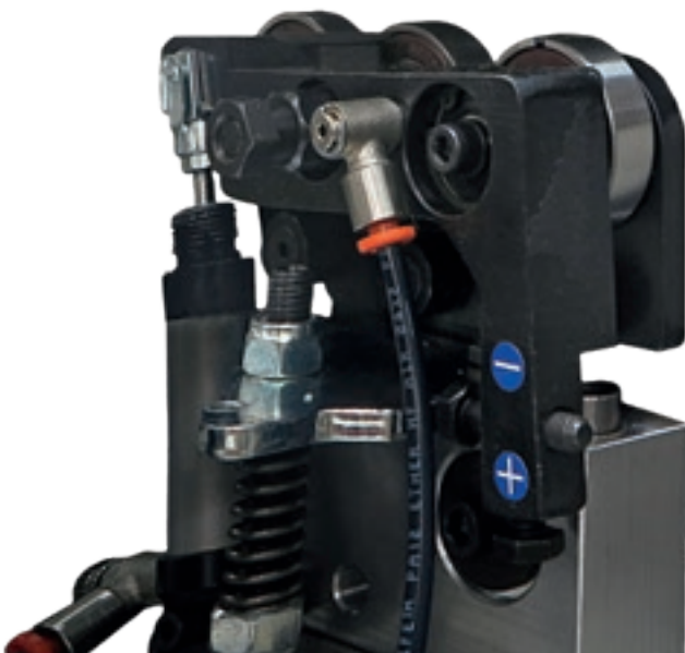
O Grupo Raspador de Cola , que remove os excessos de cola na parte superior e inferior do painel, é o único no mercado equipado com 4 cilindros pneumáticos, para garantir uma alta qualidade de acabamento.
